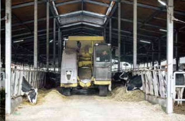
大量の牧草を牛の目の前まで運ぶミキシングフィーダー。
